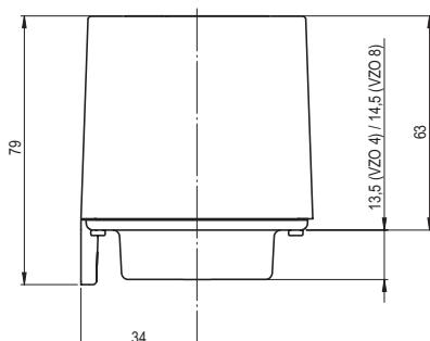
mit Impulsgeber / with pulser / avec émetteur d'impulsions
